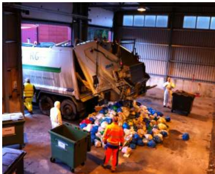
Bilde 2: Tømming av avfallet fra ett boligområde på gulvet i sorteringsanlegget.
